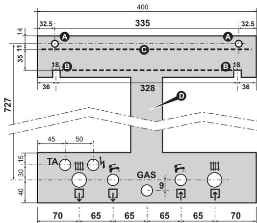
**Примечание:** Как дополнительная опция предлагается специальный металлический шаблон многоразового использования ( D на рисунке), облегчающий позиционирование точек крепления (с использованием оригинального Комплекта подсоединения). Если не используется металлический шаблон многоразового использования и / или оригинальный Комплект подсоединения, о позиции гидравлических подключений котла можно прочесть в параграфе «Габаритные и присоединительные размеры» на стр. 15.
