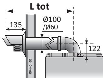
Пример горизонтальной системы «труба в трубе» (C<sub>13</sub>)
